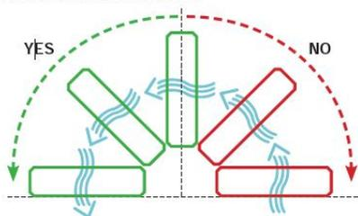
Le chauffage ne doit pas être monté flux d'air orienté vers le haut
